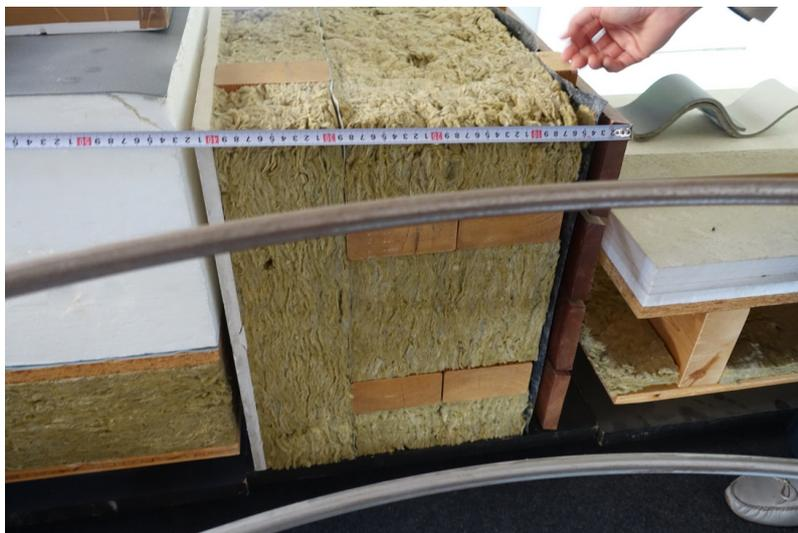
外壁と断熱材の断面図
