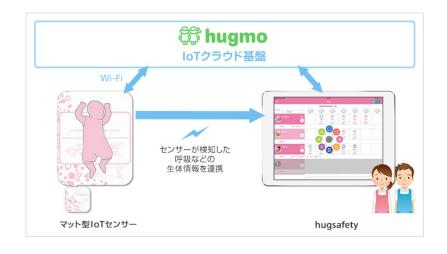
園内のある部屋(子どもを午睡させる部屋)に設置されたマット型 IoT センサー(i)が発信機となって、通常の WiFi で使用される周波数帯域の高周波が発信され、屋内の別の部屋(アルプス認定こども園では事務室)に設置された WiFi ルーター(ii)を経て、「hugmo IoT クラウド基盤」にそれが届き、そこで情報処理がなされて、その結果が再び WiFi ルーターに送られ、それがアプリ内蔵タブレット端末hugnote(iii)に届く、という方式であると推定される。
